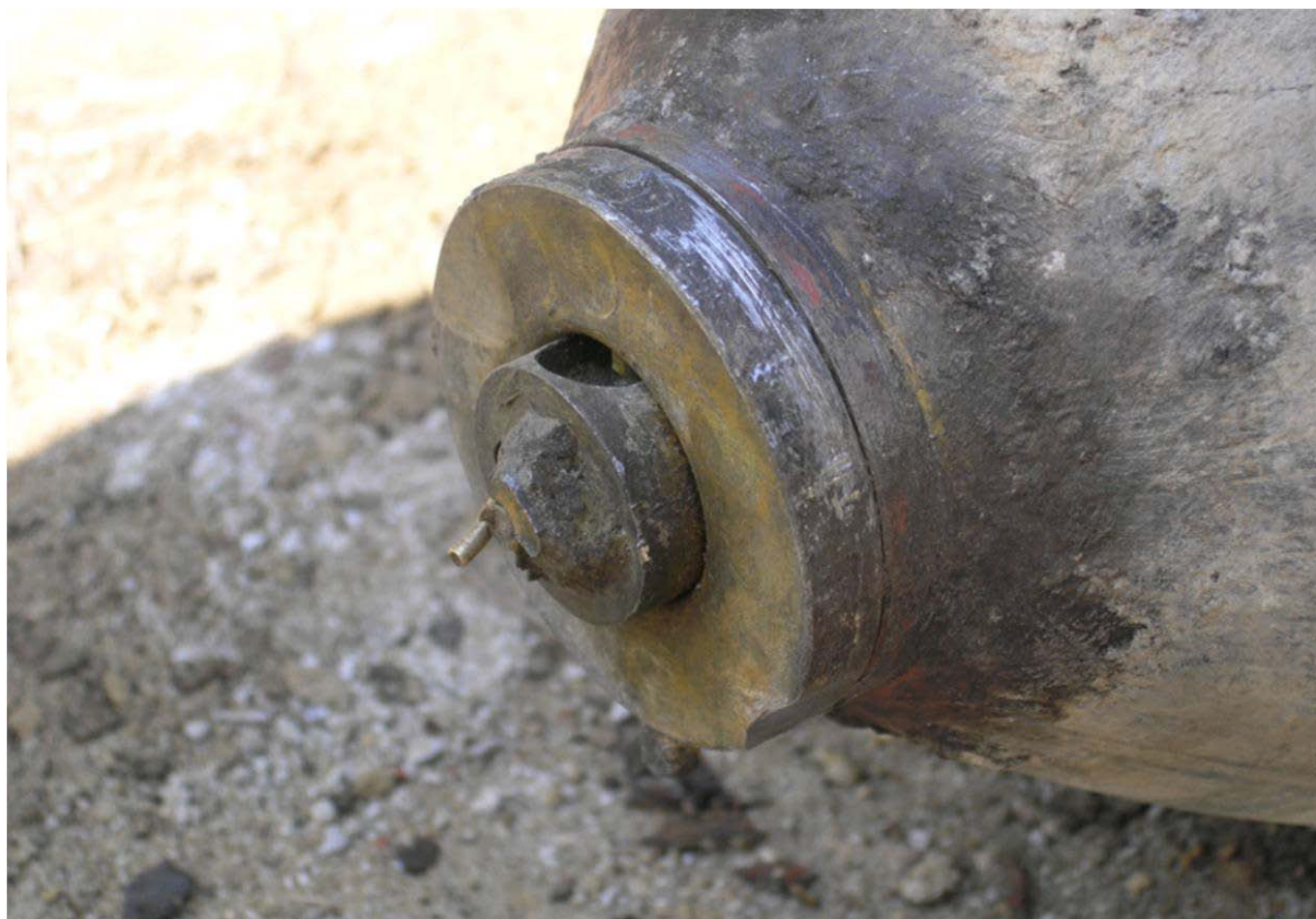
Hlavový zapalovač AN - M 103
