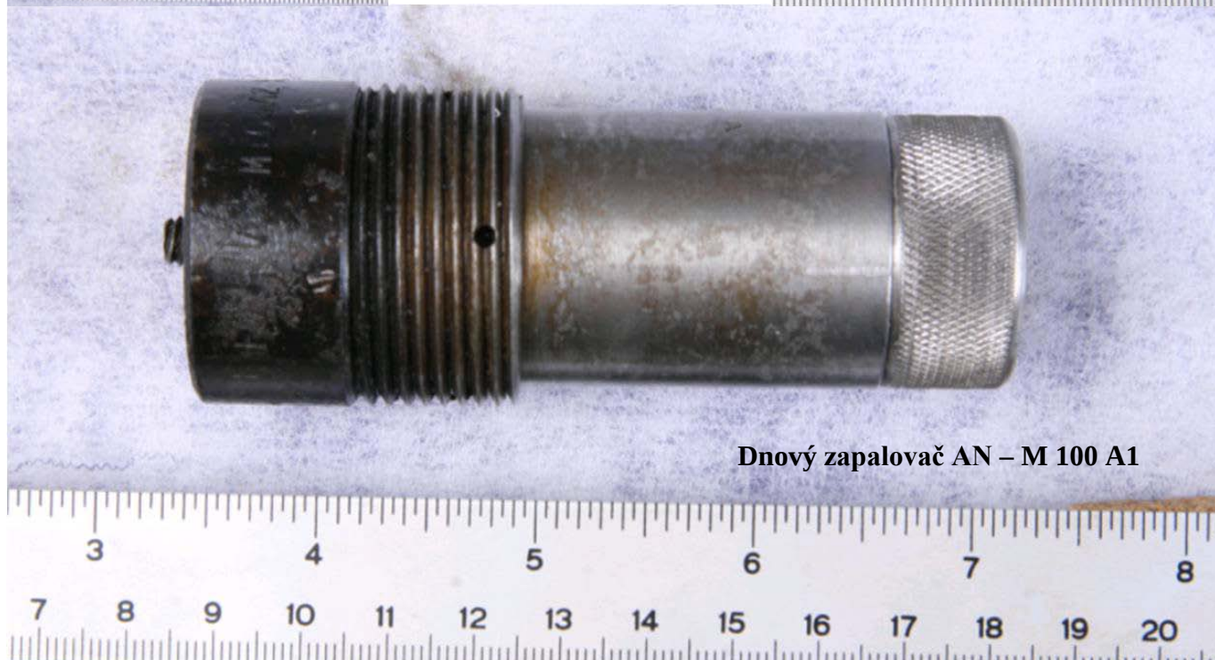
Detonátor M 14 dnového zapalovače AN – M 100 A1
