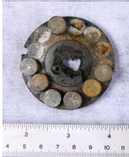
Pojistné válečky hlavového zapalovače AN – M 103
