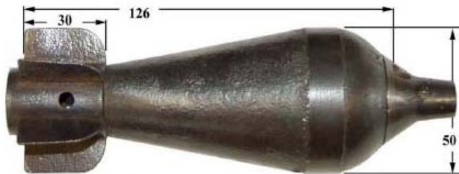
Francouzská inertní minometná střela Grenade de 50 mm mod. 1927 se zapalovačem Schneider mod. 1926
